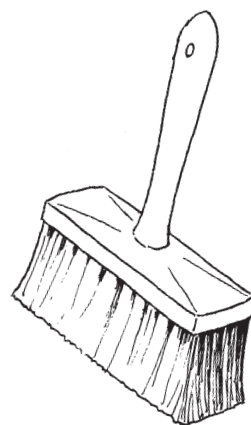
Limfärgs- eller plafondpensel. Användes förr alltid vid anstrykning med limfärg. Numera mest ihågkommen som pensel för tapetklistret. Ill. Bertil Bonns.
